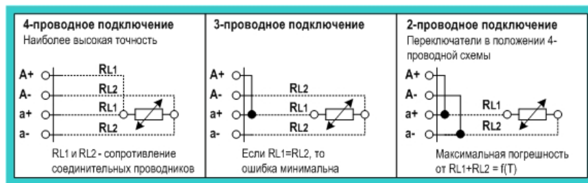
Варианты подключения термопреобразователей сопротивления
