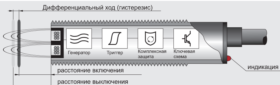
Рисунок 1. Схема функциональная индуктивного датчика с комплексной защитой
